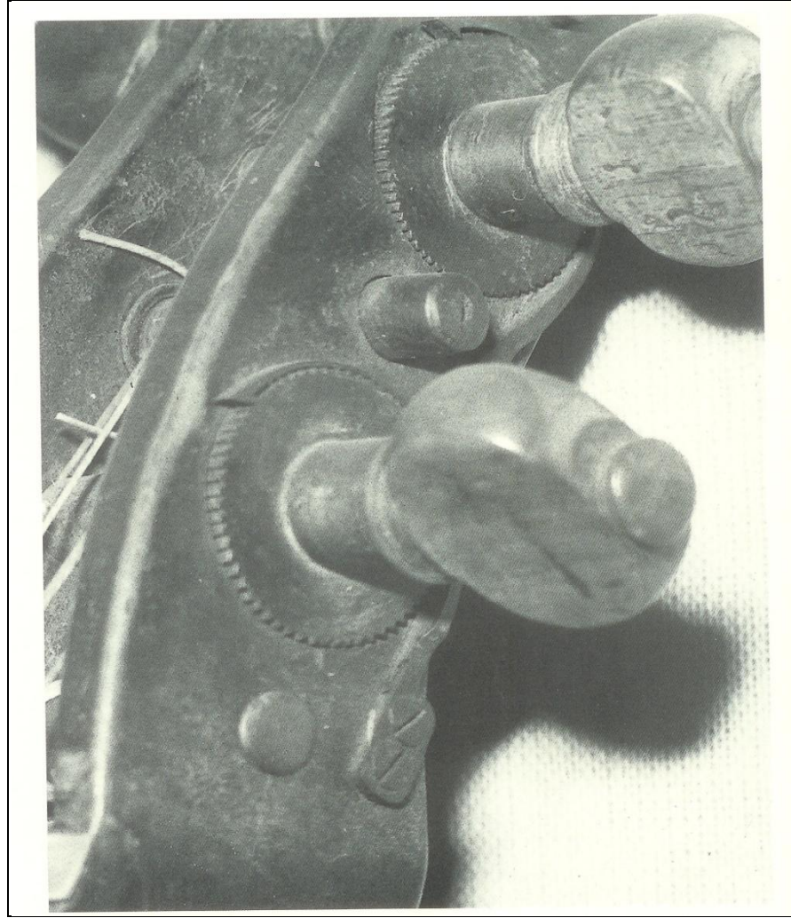
RESİM 8: ON SEKİZİNCİ YÜZYILIN İLK YILLARINDA YAPILMIŞ OLAN AKORT MEKANİZMASI.
