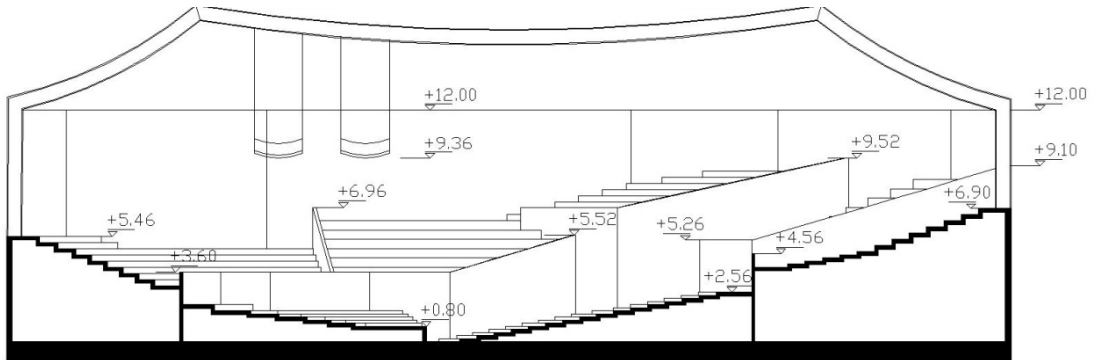
Şekil 4.108 : Yansıtıcı panel kesit şeması
