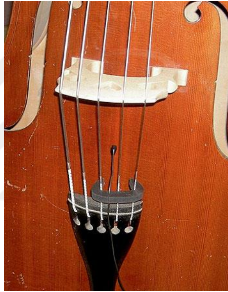
Şekil 56- SoundLab, mikrofonun kontrbas bağlantı şekli
