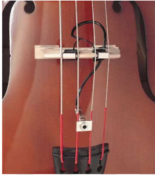
Şekil 64- Fishman BP100, piezo alıcının montajlı hali
