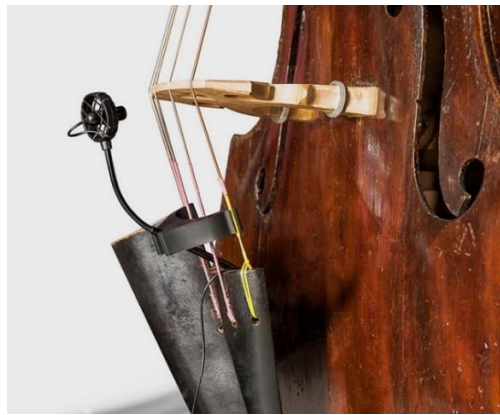
Şekil 57- Prodipe BL21, mikrofonun kontrbas bağlantı şekli
