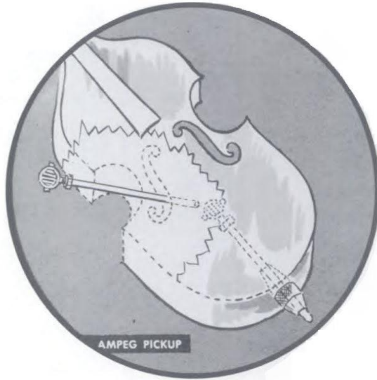
Şekil 46- Ampeg kontrbas alıcısı, iç yapısı
