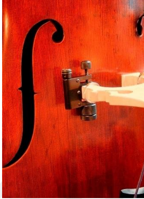
Şekil 66- The Realist SoundClip, piezo alıcının montajlı hali
